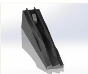
Simulation de mouvement : des comprimés pharmaceutiques doivent être retournés pendant leur conditionnement dans un but de contrôle qualité ; le logiciel aide à prévoir ce point de retournement sur la chaîne de conditionnement.
